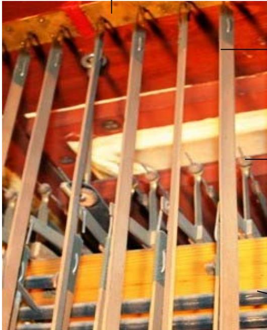
▪ La varilla del teclado 1º saliente de la reducción conecta directamente con el tiro de la ventilla. Para evitar el escape del aire del arca una chapa metálica ajusta al paso del tiro
